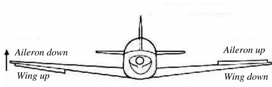
Fig (2.20) Action of aileron.
